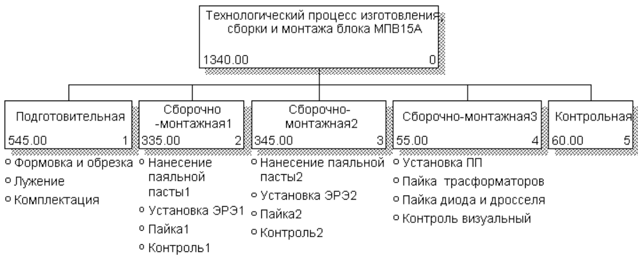
Рис 1. Визуальная диаграмма ТП изготовления блока МПВ15А
