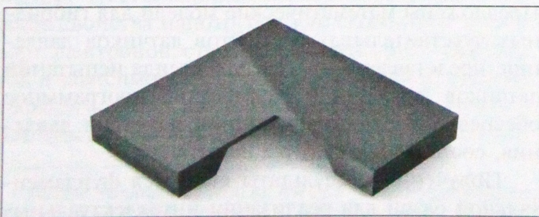
Рис. 1. Твердотельная трехмерная модель кремниевого кристалла с вырезанной четвертью
