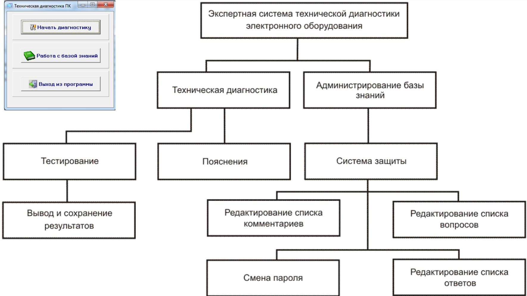
Разработанная системы включает два модуля: диагностика неисправности и редактирование базы знаний
