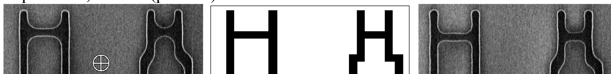
Рис. 14. Фрагменты топологии «Н-транзистора» и травленные ТС с ОРС и без
