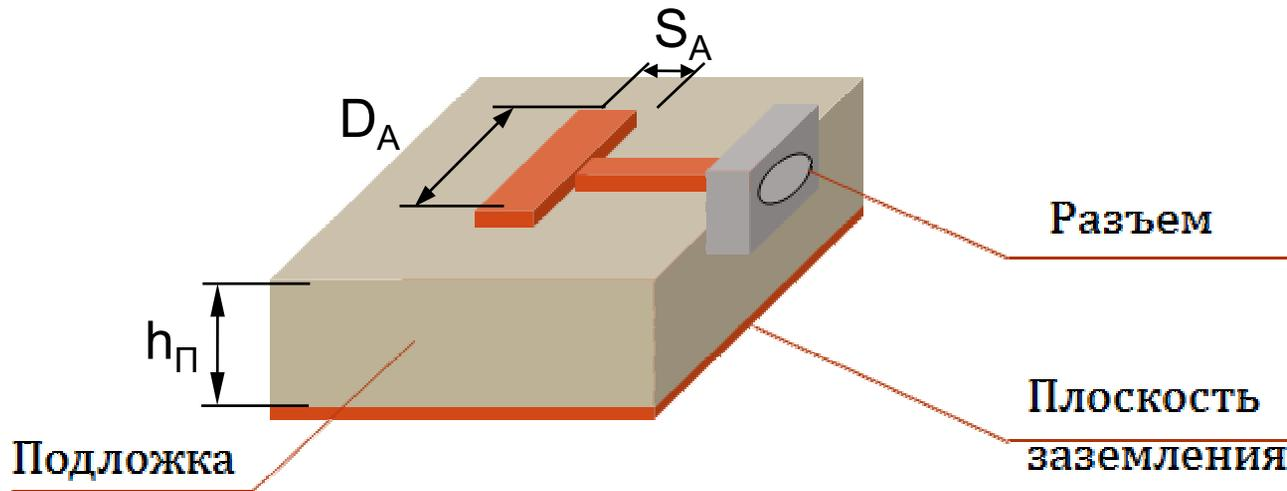
Наибольшее применение в системах RFID нашли микрополосковые антенны (МПА). В своём простейшем виде они представляют печатные платы, покрытые металлизационным слоем с обеих сторон, одна из которых выполняет функции «земли». На другой стороне формируется площадка, на которую подается питание.
