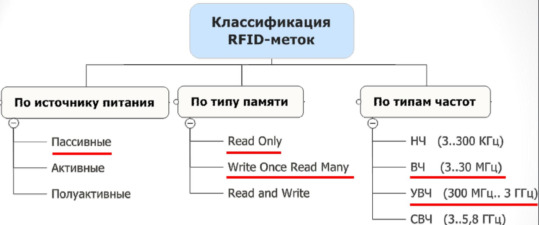
На основе проведенного анализа существующих систем RFID было решено в качестве объекта дальнейшего исследования выбрать метки: пассивные; типа «только для чтения» и «однократная запись, многократное чтение»; работающие в ВЧ и УВЧ диапазонах. Сделанный выбор определил направление дальнейшей разработки антенных модулей систем RFID.
