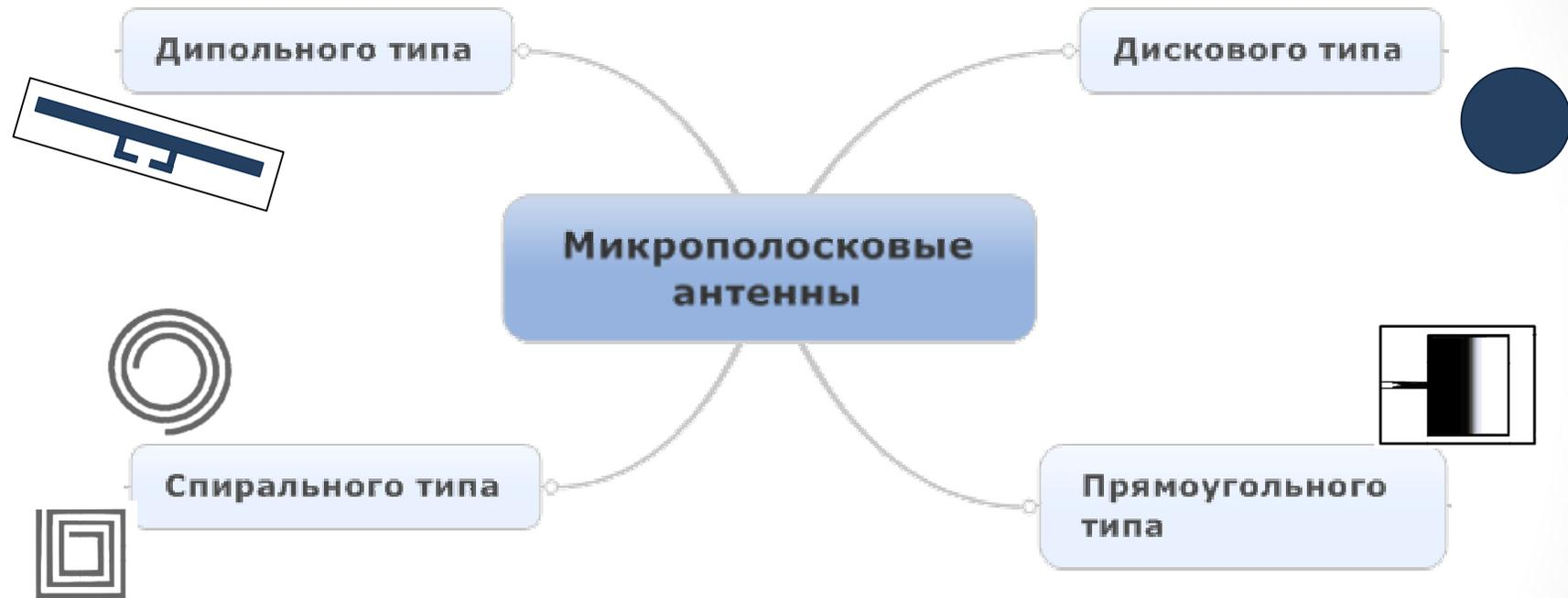
Необходимость микроминиатюризации антенны определяет её конструктивные особенности. Для дальнейшего исследования были выбраны микрополосковые антенны спирального и дипольного типа.
