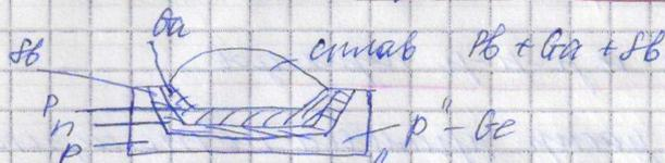
Нагрев  $\approx 720^\circ\text{C}$ : сталь растворяется и при этом диффундирует вглубь p-Ge
