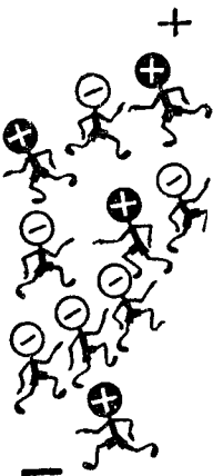
Рис. 15. Прохождение тока через p - n переход. На рисунке обозначены только носители зарядов: электроны (помечены знаком минус) и дырки (помечены знаком плюс), а доноры области n и акцепторы области p для большей ясности опущены.
