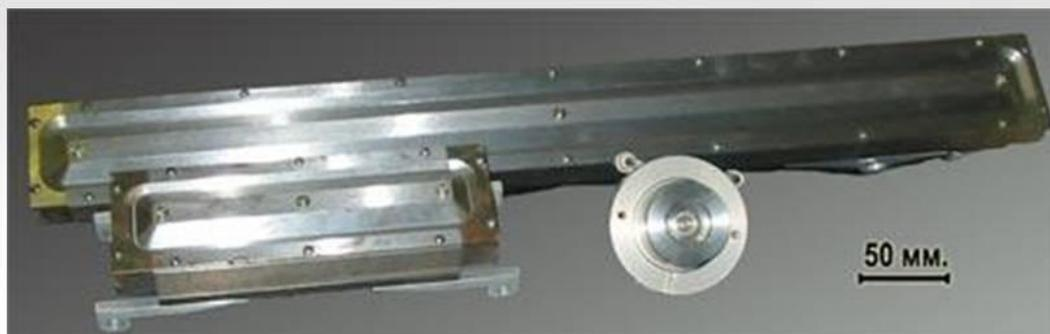
Протяженные ионные источники предназначены для очистки изделий в вакуумных камерах перед нанесением, а также для процессов ионного ассистирования в процессе нанесения и для травления тонких слоев материалов как ионным распылением (Аргон), так и ионно-химическим травлением ( фреоны, элегаз и т.д.).
