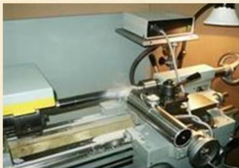
БУФО состоит из источника питания — ультразвукового генератора (см. рис.), акустической головки ГА с приводом давления и соединительных шлангов для присоединения генератора к ультразвуковой головке и обеспечивающих подачу электрической энергии от сети к генератору; для охлаждения акустической системы применяется водопроводная вода, СОЖ.
