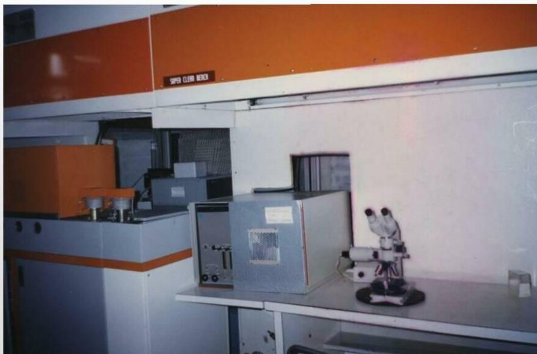
**Установка плазмо-химического удаления фоторезиста с емкостно-индукционной системой возбуждения ВЧ-разряда:**
