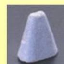
Галтовочные или притирочные тела (чипсы) – это специально изготовленный шлифовальный инструмент в виде треугольной призмы высотой 3-30 мм и цилиндра диаметром 2,5-30 мм с абразивным компонентом (микрошлифпорошком) или без него (фарфоровые чипсы), с прямым или косым срезом.
