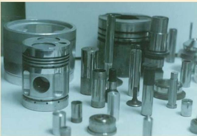
Метод БУФО не заменяет шлифовку, изменение размеров происходит в пределах нескольких микрон. Если говорить о незакаленной стали, то после одного прохода излучателем шероховатость уменьшается с 6,3 до 0,1 мкм, то есть с четвертого класса точности сразу получается десятый. Для закаленных же сталей шероховатость снижается с 0,4 до 0,025 мкм – с 8 до 12 класса точности.
