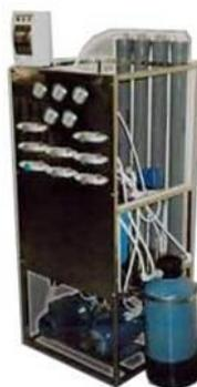
3. Обессоленная вода подаётся на ионообменные фильтры (фильтр с катионообменной смолой в Н+ форме, фильтр с анионообменной смолой в ОН- форме, фильтр смешанного действия) для глубокой деионизации
