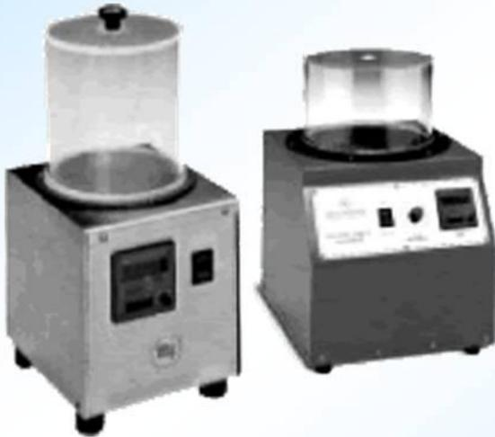
Принцип действия установки основан на активной обработке поверхностей помещенных в барабан изделий, вращающихся под действием переменного магнитного поля обрабатываемыми телами. В качестве обрабатываемых тел применяются "иголки" из нержавеющей стали.
