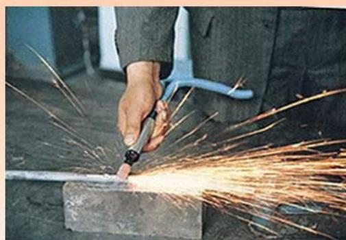
Пневматическая пальцевая шлифовальная машинка повышенной мощности. Применяется для финишных работ на инструментах для шлифования, снятия заусенец, фрезерования и полирования деталей.
