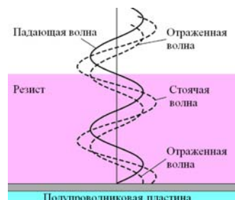
Рис.2.2.3. Возникновение стоячих волн в фоторезисте.
