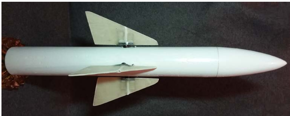
Рис. 1. Отсек управления ракеты, оборудованной данной СУ
