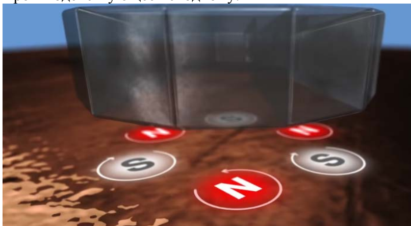
Рис. 1. Взаимодействие вращающегося магнита с проводящей пластиной
