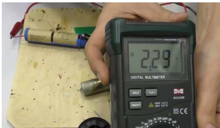
Рис. 10. Проверка работоспособности спаянных аккумуляторов
