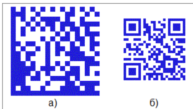
Рис. 1. Примеры графических маркеров-штрихкодов, полученных в системах Data Matrix (а) и QR (б). На маркерах закодировано сообщение «TECHNOLOGY&SYSTEMS-2017»
