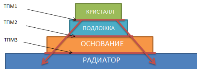
Рисунок 4.1 – Распределение тепла элемента электронного устройства ТПМ – теплопроводящие материалы для разных уровней применяются разные. В таблице 4.1 описаны ТПМ 3-х теплопроводящих уровней.
