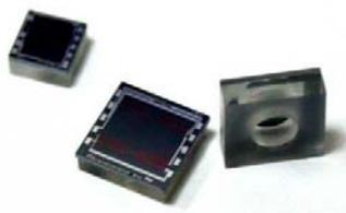
Датчики оснащены современными МЭМС кремниевыми тензорезистивными сенсорами которые имеют высокую перегрузочную способность в 100 - 150 раз превышающую верхний предела измерений. На фотографии представлен кремниевый тензопреобразователь давления соединённый со стеклом марки «Пирекс» методом электростатической сварки
