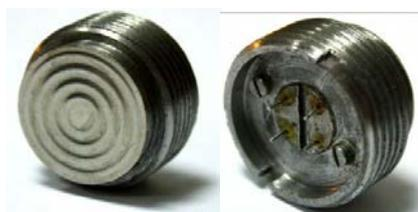
На фотографии представлен тензорезистивный сенсор, защищённый от воздействия внешней среды металлической разделительной мембраной из нержавеющей стали 316L. Давление передаётся через кремнеорганическую жидкость, которая находится между сенсором и мембраной. Данный сенсор может встраиваться в любой корпус или применяться самостоятельно. Сенсор устойчив к гамма и нейтронному излучениям.
