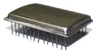
Многоточечный измерительный модуль, объединяющий 12 кремниевых тензопреобразователей в одном корпусе и позволяющий проводить одновременно замеры в 12 точках.
